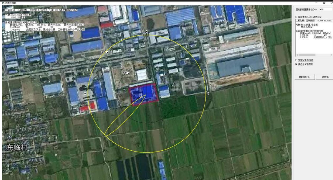
图 7.8.1-2 SO 2 各阈值的廓线对应的最大影响范围图（最不利气象条件）
